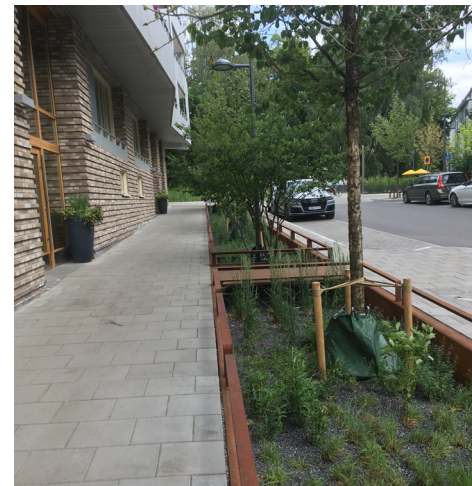
Fotot visar en öppen dagvattenbädd med en bredd på ca 2000 mm. I Orminge återfinns denna bredd längs Kanholmsvägen längst söderut.
